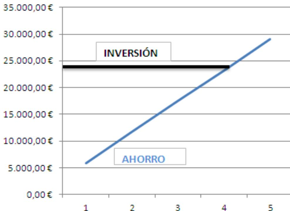
A la vista de la gráfica se observa que en el cuarto año se amortiza totalmente la inversión realizada con los ahorros conseguidos por la reducción en el consumo y en el mantenimiento de los equipos.
